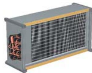
Теплообменники биметаллические из Cu/Al, Cu/Cu и Cu-Sn/Cu-Sn (трубки/оробрение). Корпус изготовлен из оцинкованной или нержавеющей стали. Воздухоохладители укомплектованы наклонными поддонами из нержавеющей стали и оцинкованными или пластиковыми каплеуловителями.
