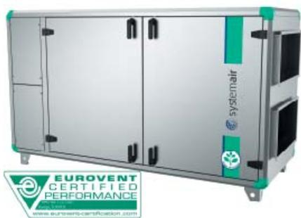
Торvех SX/C – воздухообрабатывающие агрегаты с противоточным теплообменником, предназначенные для вентиляции учебных заведений, медицинских учреждений, офисов и других небольших помещений, а также для зональной вентиляции больших помещений. Агрегаты Торvех SX/C укомплектованы вентиляторами с ЕС-двигателями, для удовлетворения современных энергетических требований и имеют очень низкое энергопотребление и высокоэффективную теплоутилизацию.
